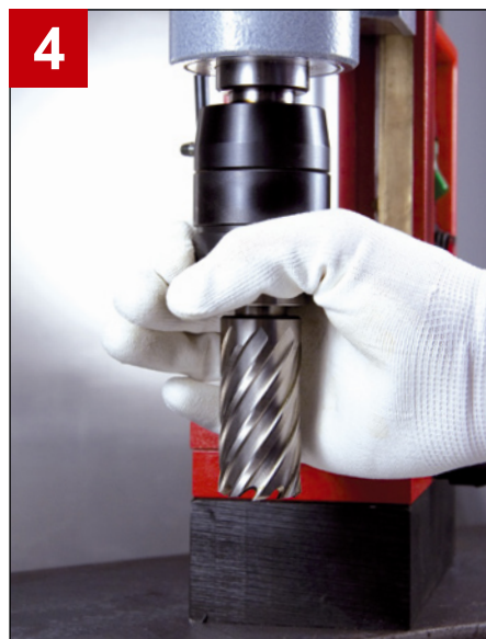
photo 3: La fraise est maintenue dans le Easy Lock. La machine est prête à l'emploi.
