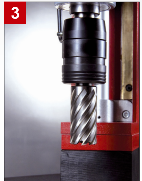
photo 4: Pour démonter la fraise, pousser la bague vers le haut.
